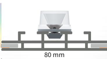
beidseitige, homogene Ausleuchtung dank qualitativ hochwertiger OSRAM LED Technik mit speziell angepasster Linsenform.
